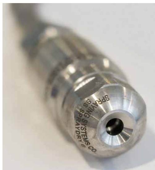
De sproeidroger kan met een of twee hogedruknozzles (tot 80 bar) sproeien.
