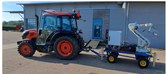
Figuur 4. Mobiele proefopstelling met robot arm en gripper op een mobiele kar
