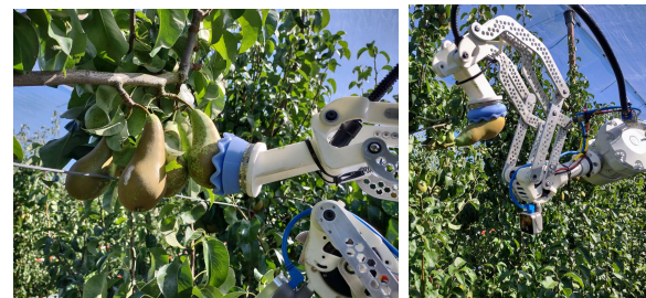
Figuur 5. De ontwikkelde gripper tijdens de experimenten in de boomgaard
