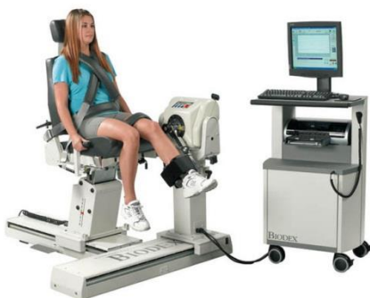
Afbeelding 1. Spierkrachtmeting met de Biodex
