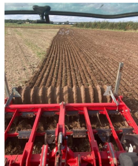
Figuur 8 Stoppelbewerking met vaste tand cultivator na hennepoogst
