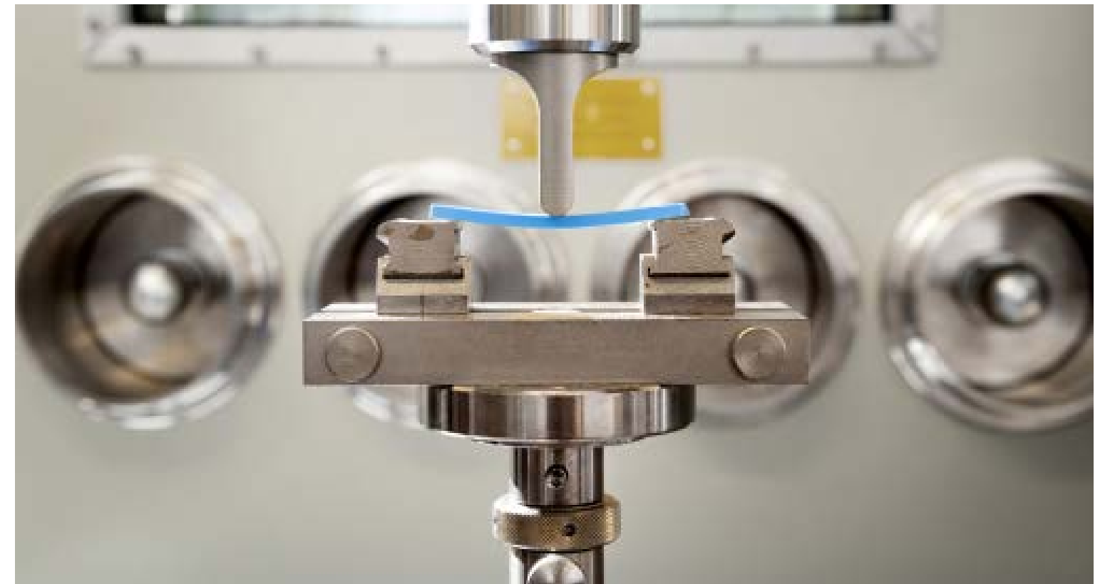
Test van plastic op de buigzaamheid.
