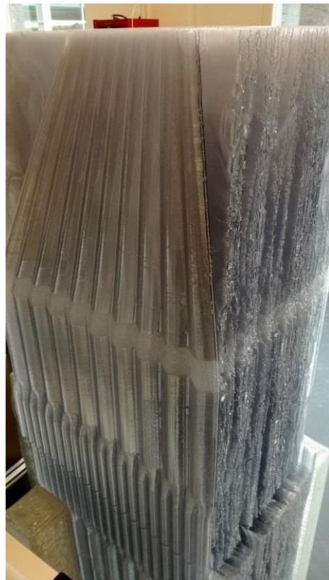
Structuur van een gevel met buisjes voor warmteuitwisseling (gemaakt met een 3D-printer)
