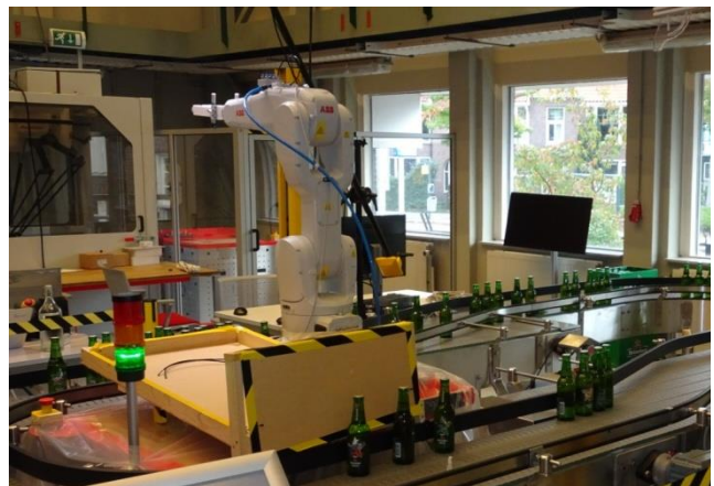
Testopstelling voor het detecteren en weer overeind zetten van omgevallen bierflesjes
