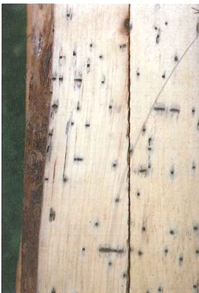
Fig. 7 De eikenhoutkever en andere ambrosiakevers maken diepe gangen in het hout van verzwakte eiken waar ze van zwarte schimmels leven (foto: W.H. Bennett, USDA)
