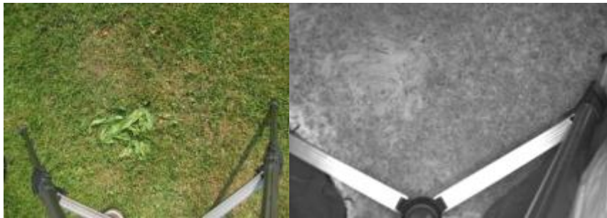
Figuur 2. Opname van onkruid in gras. Links: met kleurencamera. Rechts: met infrarood camera.
