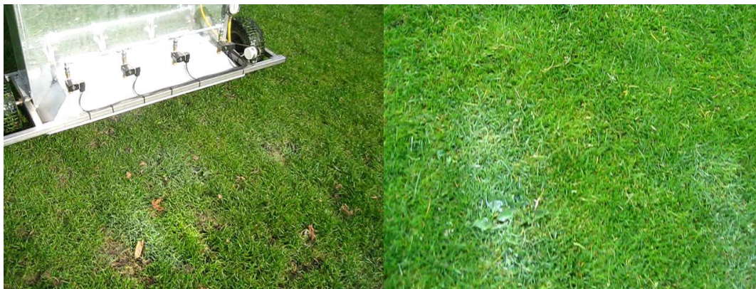
Figuur 13. Veldtest van het prototype op praktijkschaal. Er wordt gespoten met een witte kleurstof om na te kunnen gaan of er op de juiste momenten gespoten wordt. In deze foto's is te zien dat de kleurstof te dik is om homogeen verspreid te worden. Op de foto links is te zien dat elke spuitdop een eigen spoor nalaat. Op de foto rechts is te zien dat de aanwezigheid van een onkruidje de spuit aanzette en dat deze vrij lang aan bleef staan.
