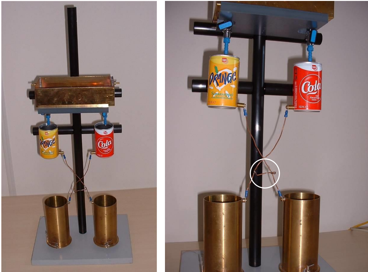
Figuur 4: Overzicht van de Kelvindruppelaar. In de cirkel zie je de puntjes waartussen de ontlading moet plaatsvinden.
