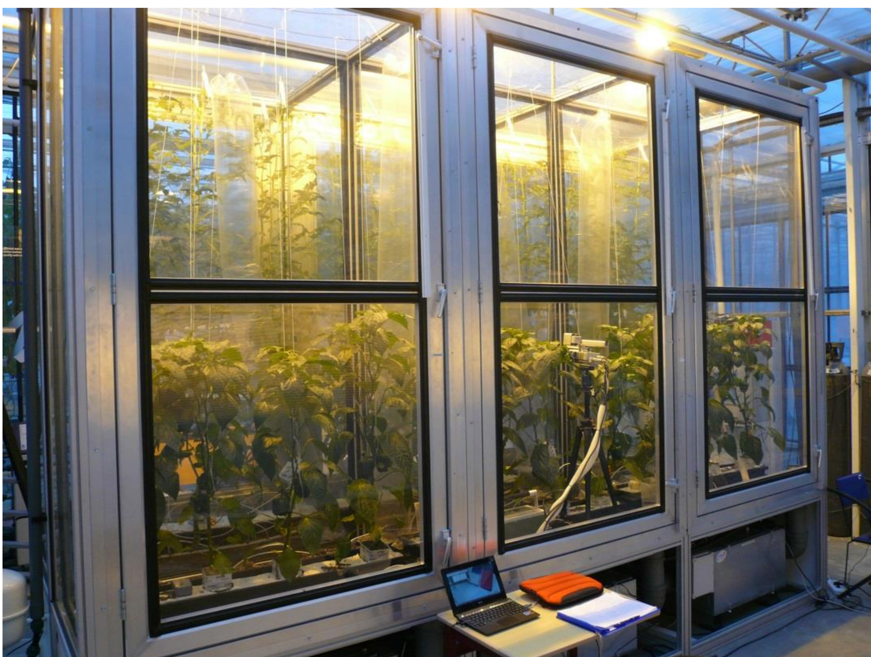
Foto 1: compleet stuurbare CO 2 cabines in de 'CO 2 faciliteit'.
