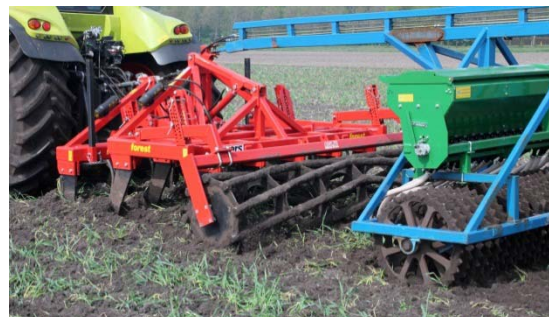
Meerdere bewerkingen in één werkgang zoals een cultivator met voorzetwoeler en vorenpakker houden de bodemstructuur beter intact.
