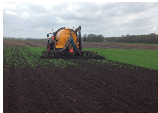
Mestinjectie bij hoge rijsnelheden kan leiden tot een fijne structuur die stuif- en slempgevoelig is.
