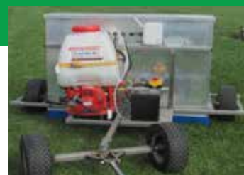
Prototype van de sensor gestuurde gewasbescherming
