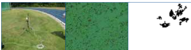
Meetopstelling (links) close up beeld van sportveld met breedbladig onkruid (midden), beeldanalyse t.b.v. detectie en positie-bepaling van het onkruid (rechts, zwart is positieve detectie onkruid)
