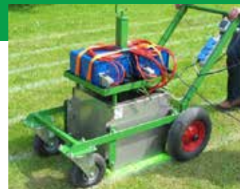
Prototype van de UV-onkruidbestrijdingsmachine
