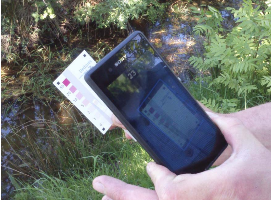
Foto: Analyse van de kleur van nitraatstrookjes met een app op een smartphone
