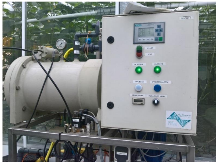
Figuur 5. MT-IBA filter van Fiber Filtration (afdeling ongebufferd kokos) verwijdert deeltjes tot 0.4 \mu\text{m} .
