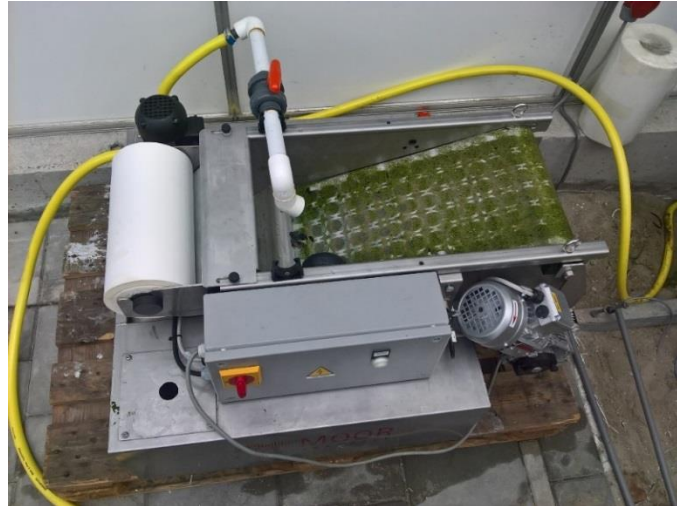
Figuur 6. Vlakbedfilter van Brinkman (afdeling gebufferd kokos) verwijdert vaste deeltjes tot 35 \mu\text{m} .
