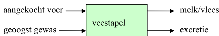
Figuur 6.3. Schematische weergave van het berekenen van de hoeveelheid P_2O_5 in het geoogste gewas op basis van de bedrijfsspecifieke excretie: P_2O_5 in geoogst gewas = P_2O_5 als melk/vlees + P_2O_5 excretie – P_2O_5 in aangekocht voer
