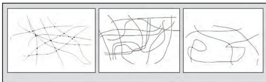
Bild 1: Struktur von Duroplasten, Thermoplasten und Kautschuk.
