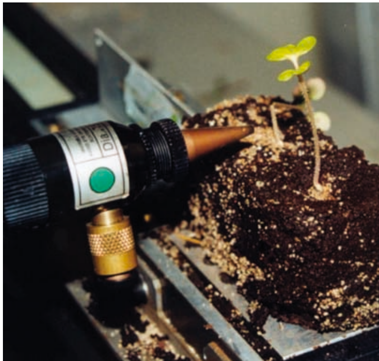
Afsnijden van onkruid met infraroodlaser in een proefopstelling
