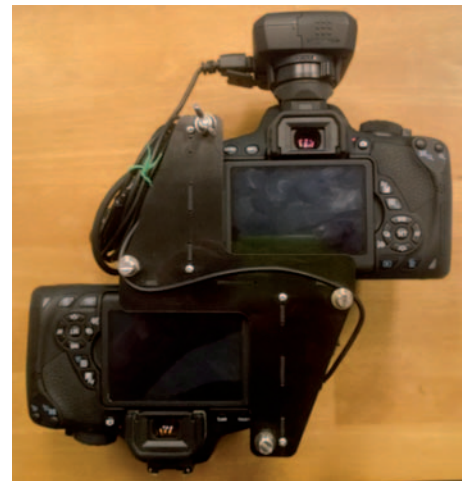
Figuur 3 - Configuratie van twee spiegelreflex camera's voor het opnemen van multispectrale beelden.
