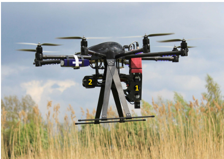
Figuur 2 - Octocopter met hyperspectrale camera (1) en fotogrammetrische camera (2).
